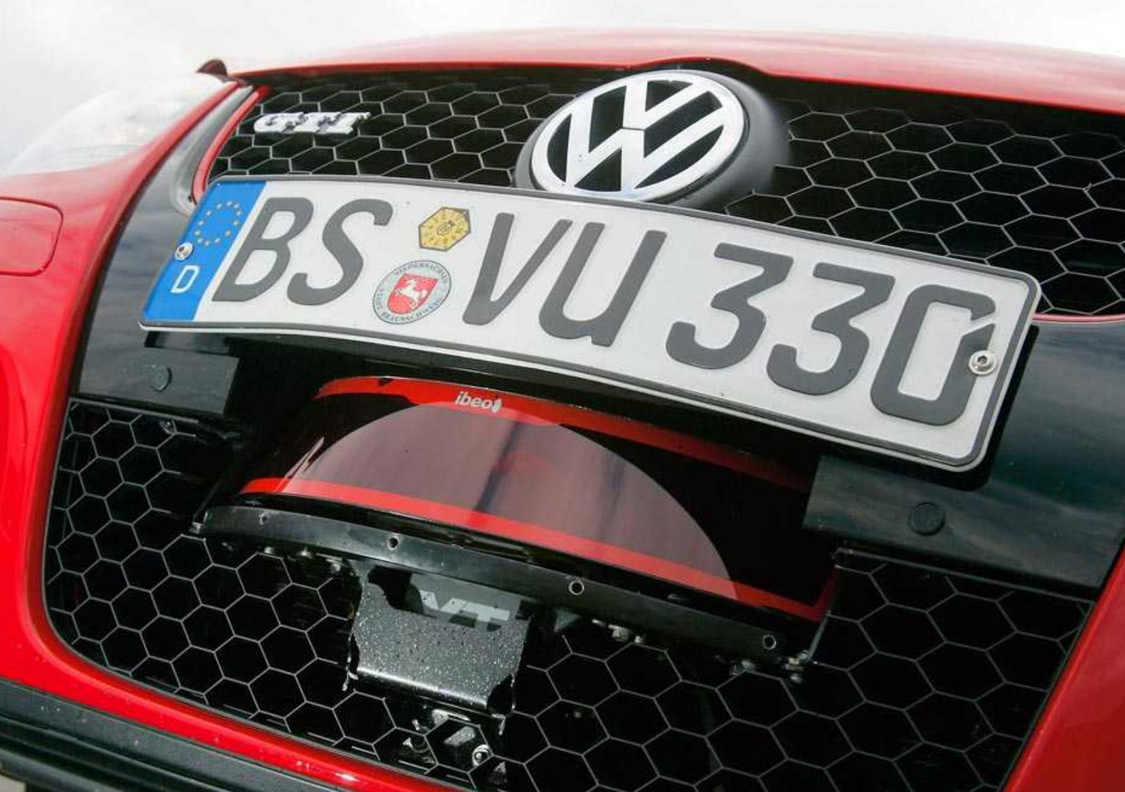
Frontbereich eines VW GolfV GTI, ausgestattet mit einem Laser-Scanner der Marke ibeo.
