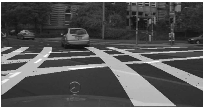
Bild 7 Ergebnis des Hypothesentests für die Kreuzung aus Bild 1(a) und 6(a). Die hellgrauen halbtransparenten Überlagerungen kennzeichnen die Suchschläuche um die neun DividerCenterlines der getesteten Kreuzungsgeometriehypothese. Das querende RoadSegment besteht zunächst aus zwei, im linken Bilddrittel über eine EntryExitLaneTransition aus drei Lanes; das selbst befahrene RoadSegment besitzt drei Lanes: die selbst befahrene, den Radweg rechts (im Gegensatz zu Bild 6(a) wurde er hier modelliert; allerdings ist er nicht durch Markierungen gekennzeichnet) sowie, nach einem dazwischenliegenden, breiten PhysicalDivider , die Gegenspur links. Für den PhysicalDivider werden zwei Suchschläuche, einer für jede Berandung, verwendet. Daraus resultieren neun Suchschläuche. Visualisiert wurde diejenige Hypothese aus einem Satz von translatorisch gegeneinander verschobenen Hypothesen mit der höchsten Güte gemäß Gleichung (7). Die korrekte Position wurde trotz beträchtlicher Abweichung zwischen Geometrie-Hypothese und Realität gefunden.
