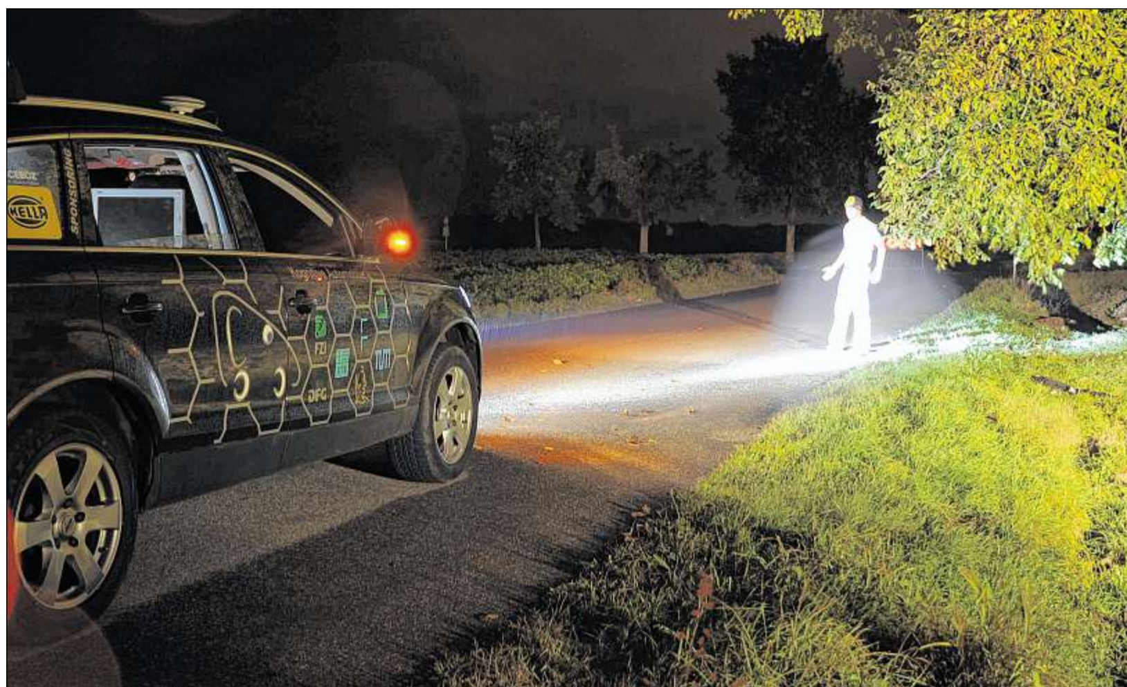
AUSGELEUCHTET: Fußgänger, aber auch Radler und Wild, die sich auf Kollisionskurs zum Auto bewegen, aktivieren ein neuartiges Fahrer-Assistenzsystem. Frühzeitig und gezielt werden damit gefährdende Objekte angestrahlt. So kann der Pkw-Lenker sein Fahrverhalten anpassen. Fotos: KIT
