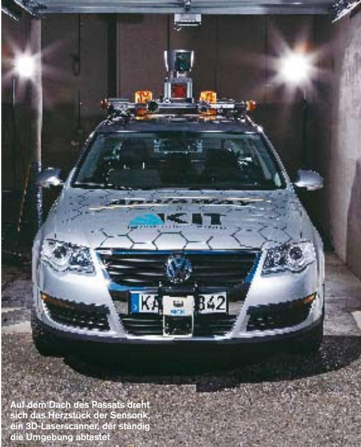
Auf dem Dach des Passats dreht sich das Herzstück der Sensorik, ein 3D-Laserscanner, der ständig die Umgebung abtastet
