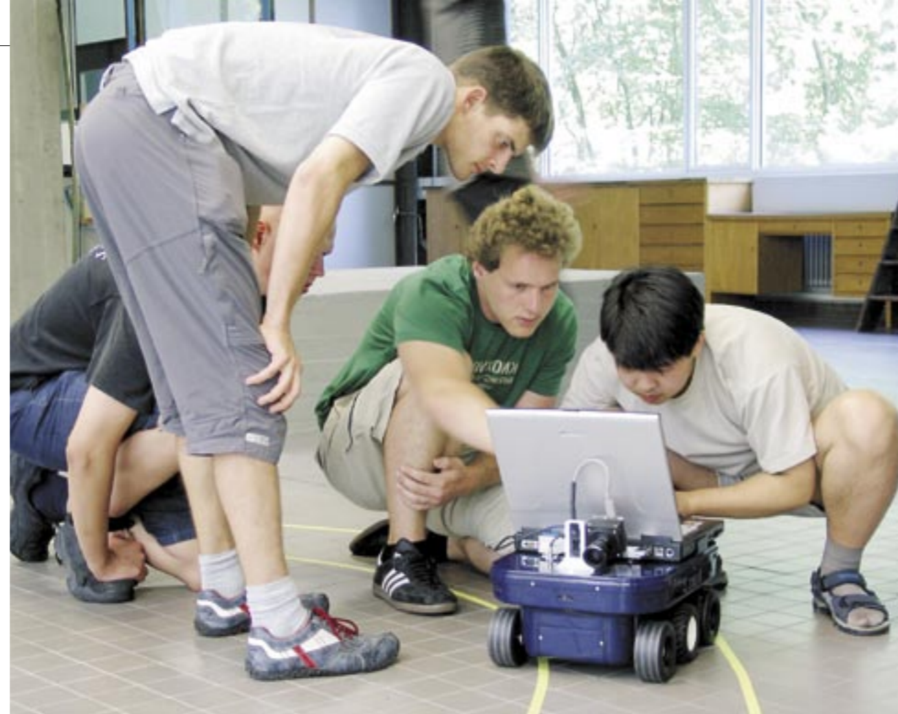
Kluge Studis, kluges Fahrzeug: Studenten machen mit ihrem „Prototyp“ eine Testfahrt im Labor für Kognitive Automobile. Eine Kamera zeigt den Weg, das Laptop steuert die Elektronik.
