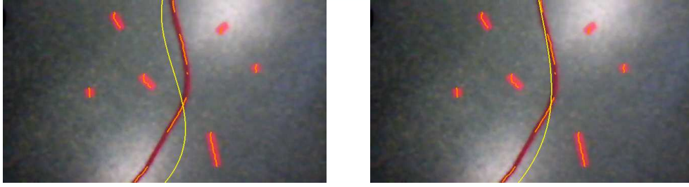
Abbildung 5: Vergleich der Polynomschätzung mit Least-Squares-Schätzer und M-Estimator bei Ausreißern in den Beobachtungen. Orange: Beobachtungen. Gelb: Geschätztes Polynom. Links: Least-Squares-Schätzer. Rechts: M-Estimator.
