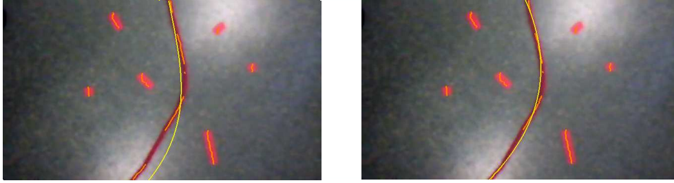
Abbildung 7: Vergleich der Polynomschätzung mit M-Estimator und RANSAC bei Ausreißern in den Beobachtungen. Orange: Beobachtungen. Gelb: Geschätztes Polynom. Links: M-Estimator. Rechts: RANSAC.
