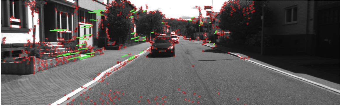
Abbildung 3: Ein Bild aus der Zweitbefahrung (Lokalisierung). Detektierte Merkmalspunkte sind in rot dargestellt. Eine Zuordnung zu einer Landmarke wird durch einen grünen optischen Flussvektor repräsentiert.
