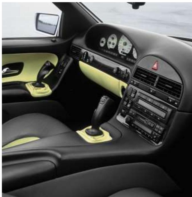
**Fig. 4:** Drive-by-Wire-System (Daimler Media Services)
