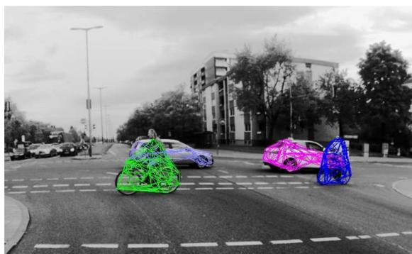
(a) Strukturmodell mit voller Fahrzeuglänge verfügbar, obwohl nur die Heckklappe sichtbar ist (b) Durch Fahrradfahrer zum Teil verdeckte Fahrzeuge
