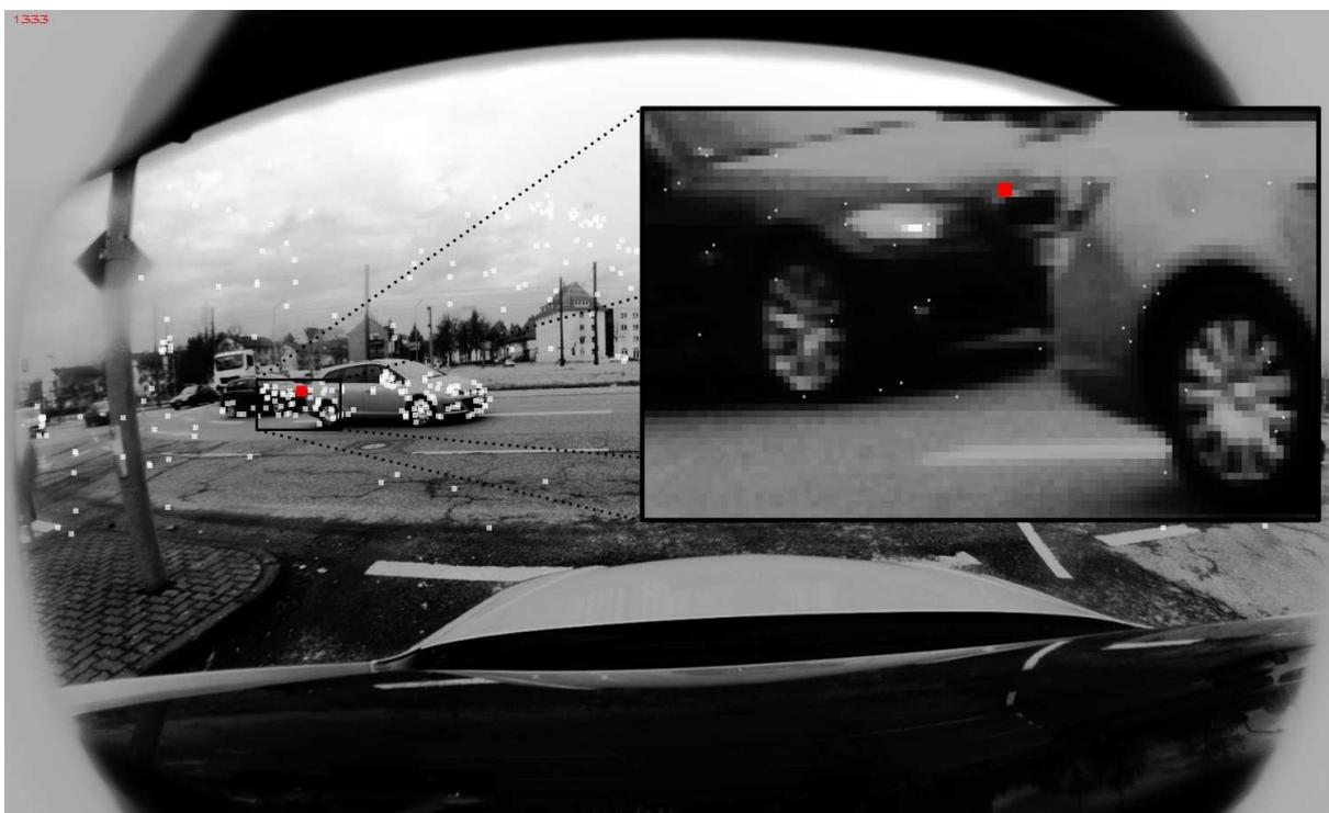
(b) ein Frame später wird ein Bildmerkmal des linken Fahrzeugs der selben Landmarke zugeordnet.
