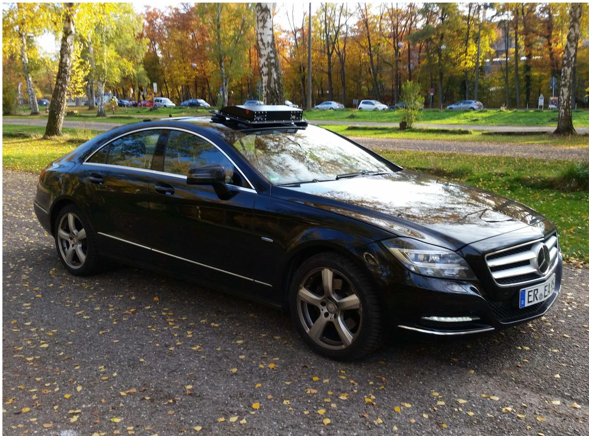
Abbildung 4.1 – Zur Aufzeichnung verwendete Atlabox auf einem Testfahrzeug
