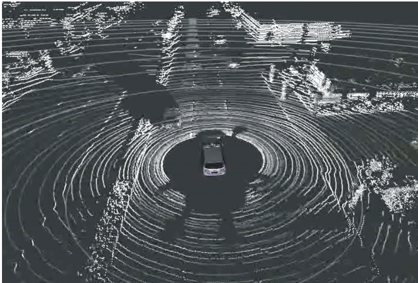
Abb. 7: Laserdaten zur Bestimmung der Objektkarte
